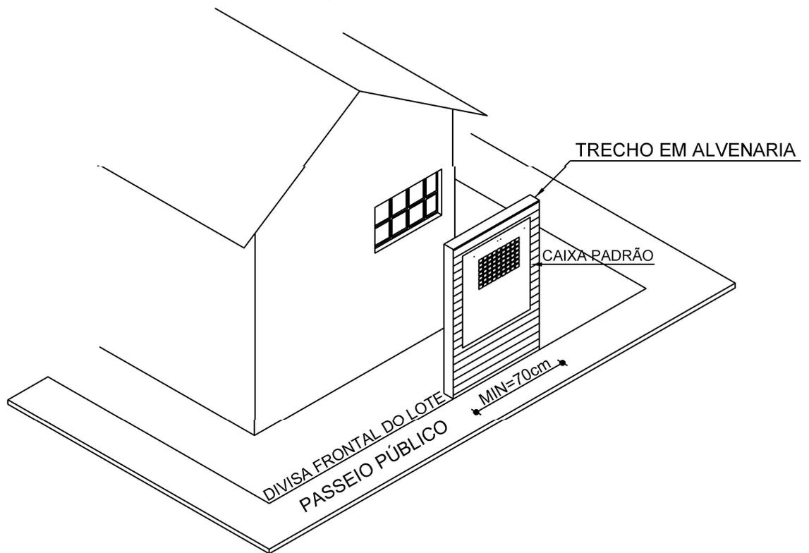
FIGURA 4 - INSTALAÇÃO FRONTAL COM GRADE
